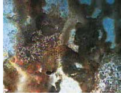
Korozyona uğramış Fin yüzeyinin mikroskop görüntüsü
